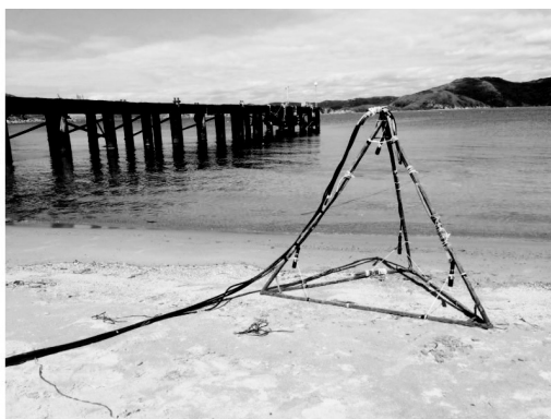
Рис. 2. Равнобедренный треугольник для определения дистанции от источника – S до гидрофона – P0 – (а.) и пирамида с тетраэдром из 4 измерительных гидрофонов – (б.).
