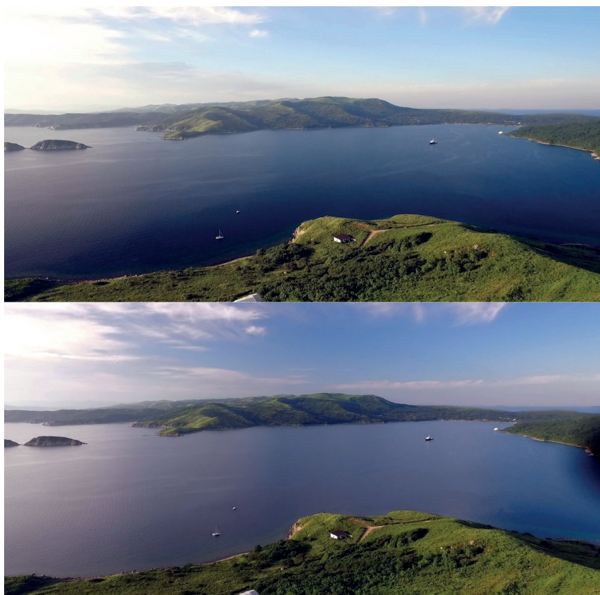
Рис. 1. Исчезновение контраста снимков в районе судна, находящегося в б. Витязь. Сверху - снимок в горизонтальной поляризации. Снизу - снимок в вертикальной поляризации.
