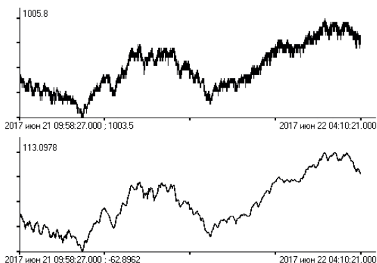
Рис. 4. Запись длительностью 18 часов метеостанции MaXiMet GMX500-5B и лазерного нанобарографа с помощью регистрирующей системы, использующей квадратурные сигналы
