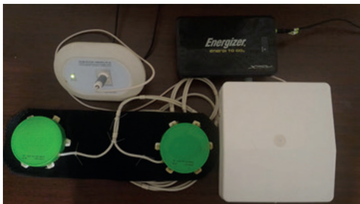
Рис. 1. Общий вид прибора «РС АЭГ-01». Вибродатчики закреплены на прорезиненной ленте и выполнены с гидроизоляцией.
