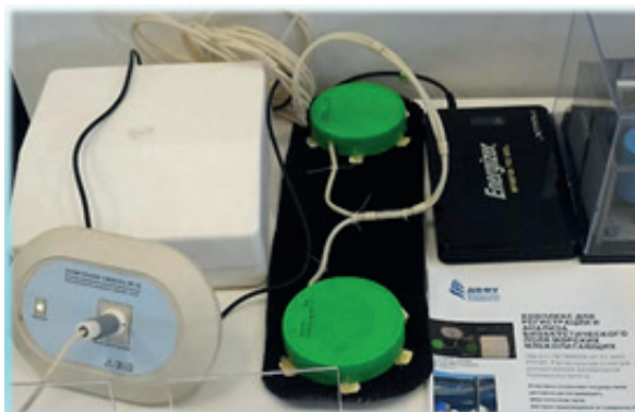
Рис. 2. Общий вид прибора «РС АЭГ-01». Вибродатчики закреплены на прорезиненной ленте и выполнены с гидроизоляцией.
