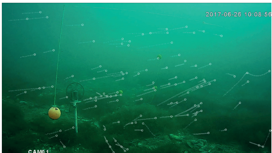
Рис. 1. Траектории частиц накопленные за 200 видео кадров при направленном течении.
