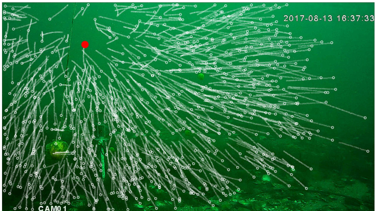
Рис. 1. Траектории частиц, накопленные за 600 кадров при направленном течении и оценка «исчезающей точки» (красный круг) из которой направлено течение.
