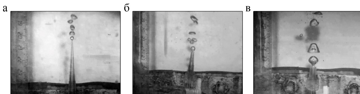
Рис. 2. Изображение пузырьков выходящих из сопел различных диаметров:
