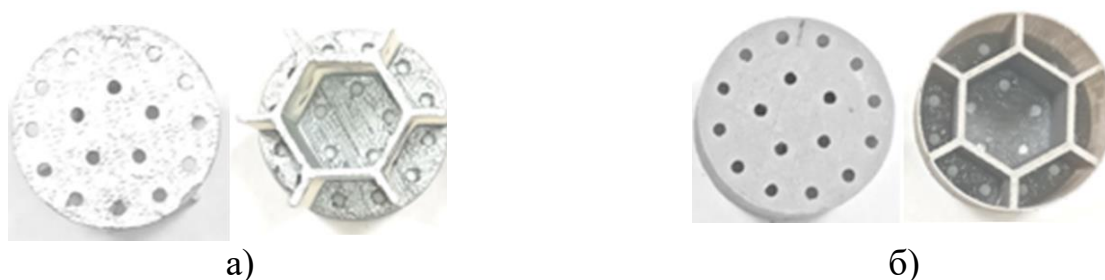
Рис. 6. Образец ЗПК диаметром 30 мм: а) без боковых стенок; б) с боковыми стенками
