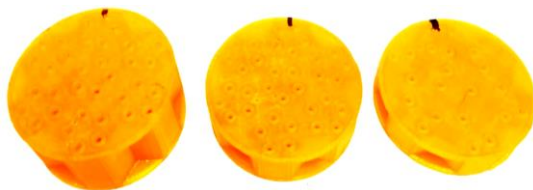
Рис. 9. Однослойные образцы ЗПК диаметром 50 мм без боковых сот
