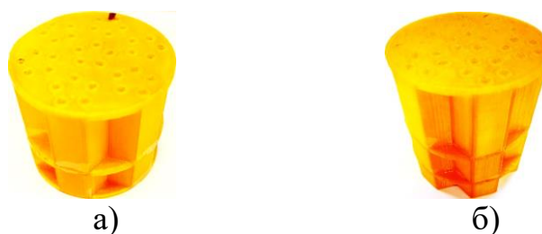
Рис. 10. Образцы многослойных ЗПК: а) двухслойный образец; б) трехслойный образец
