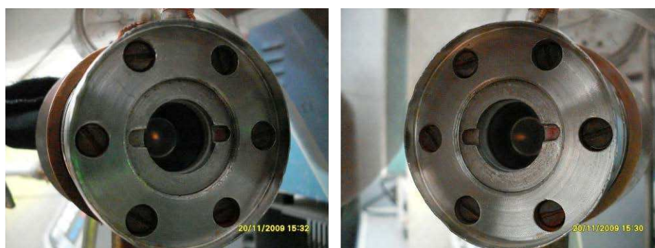
Рисунок 10.3 – Фотография многопузырьковой СЛ в насыщенном аргоном 5 М растворе NaCl.
