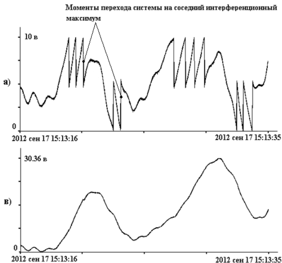
Рисунок 1.18 – Иллюстрация записи сигнала в аналоговом виде: а) фрагмент записи системы регистрации без сшивания сбросов; в) тот же фрагмент, только со сшитыми в результате обработки, или непосредственно при записи, сбросами.
