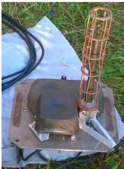
Рисунок 11.2 – Донная станция на базе параметрического двухэлементного излучателя (частоты 250-300 кГц и 50 кГц) перед постановкой в море в августе 2016 г. (справа располагается высокочастотный измерительный гидрофон)
