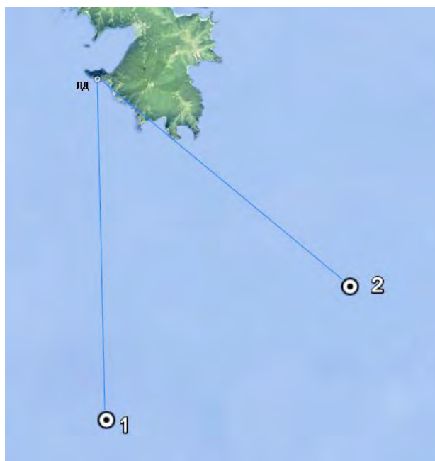
Рисунок 2.9 – Схема расположения станций гидроакустического излучения 1 и 2 относительно лазерного деформографа (ЛД).
