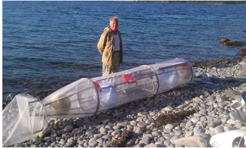
Рисунок 5.14 – Восьмиканальный приемный комбинированный модуль нейтральной плавучести. Японское море, бухта Витязь
