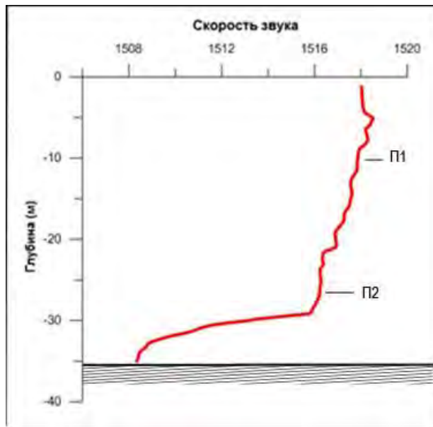
Рисунок 5.18 – Зависимость скорости звука от глубины в точке постановки приемной системы. П1, П2 – глубины постановки комбинированных приемников. Время постановки 19.09.15г.
