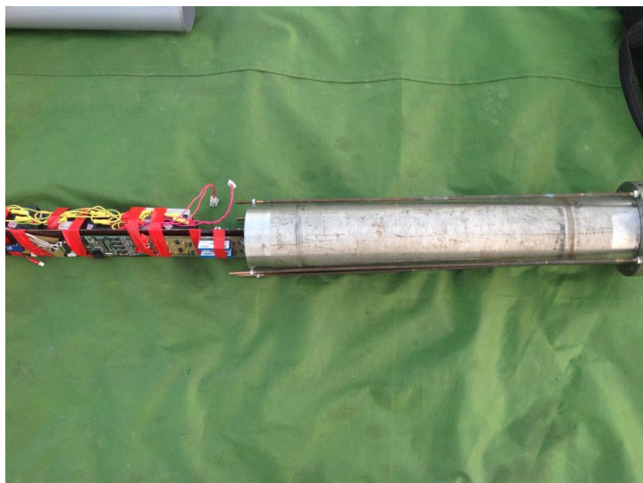
Рисунок 8.3. – Блок измерения электрического поля донной станции.
