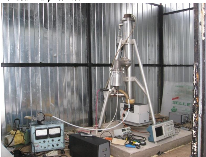
Рисунок 1.6 – Внешний вид абсолютного баллистического лазерного гравиметра в рабочем состоянии
