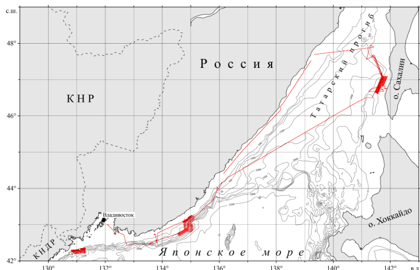
Рисунок 7.6 – Карта расположения профилей, полученных с использованием многолучевого эхолота SEA BEAM 3050 в рейсе № 70 НИС “Профессор Гагаринский” (16 мая – 14 июня 2016 г.). Рельеф дна (GEBCO, 2003)
