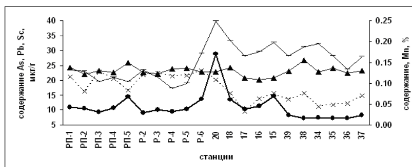
Рисунок 4.18 – Распределение содержания Pb (–), As (×), Sc (▲), Mn (●) в субколлоидной фракции донных отложений на разрезе р. Раздольная – Амурский залив
