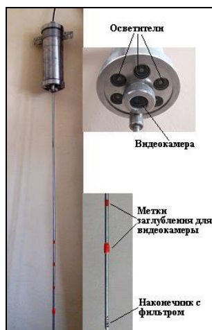
Рисунок 5.4 – Зонд для отбора проб поровой воды в донных осадках
