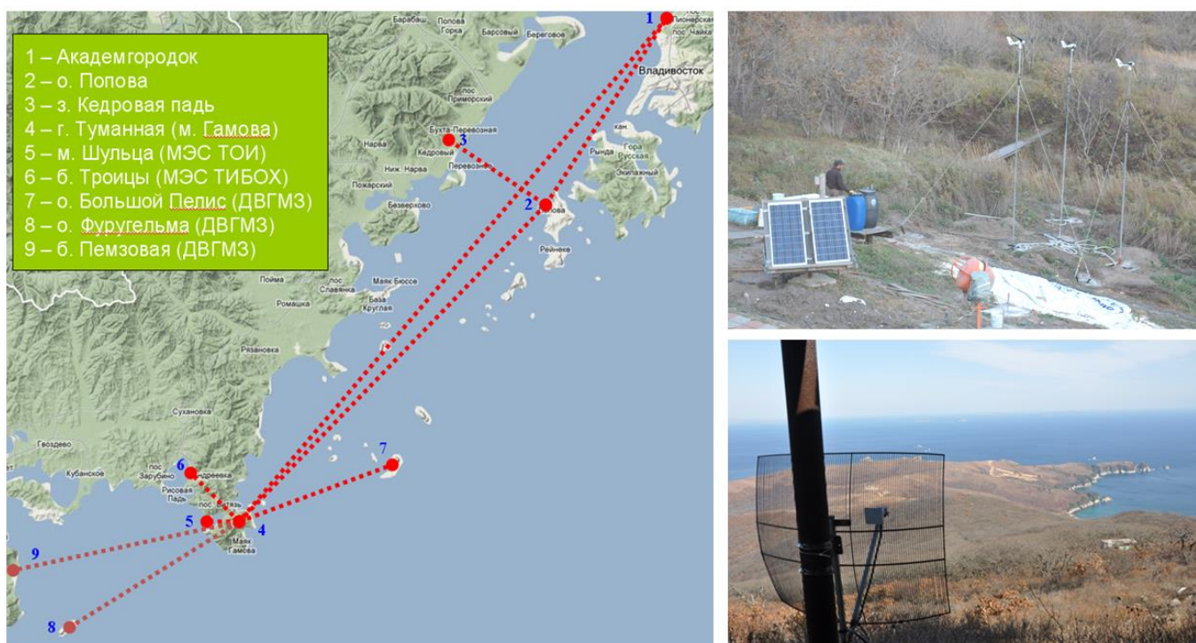
Рисунок 3.15 - Базовая радиосеть залива: схема расположения узлов; работы по установке солнечных батарей и ветрогенераторов на узловой точке о. Фургельма; радиоантенна в узловой точке на г. Туманной смотрит в направлении узловой точки о. Большой Пелис
