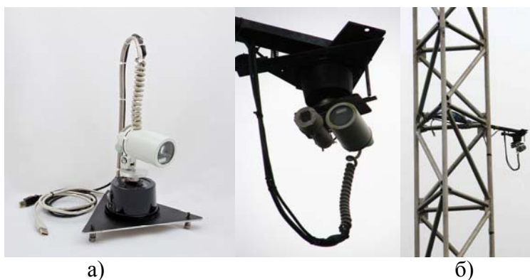
Рисунок 27 - Элементы и схема установки панорамной камеры: а) панель с элементами горизонтирования; б) вышка
