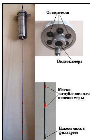
Рисунок 21 – Зонд для отбора проб поровой воды в донных осадках.
