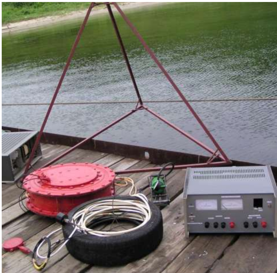
Рисунок 1.2 – Гидроакустическая излучающая система с центральной частотой излучения 33 Гц
