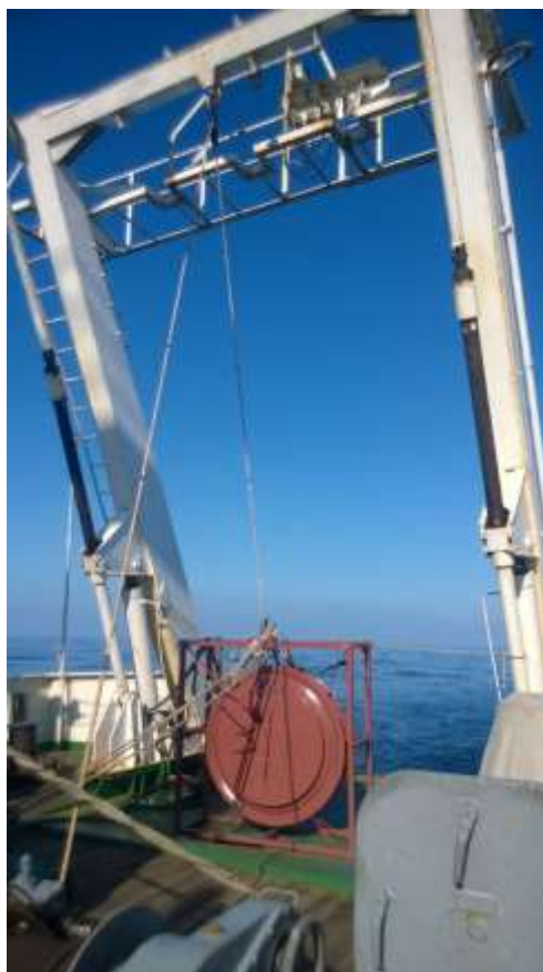
Рисунок 2.18 – Рабочее крепление излучателя на палубе судна
