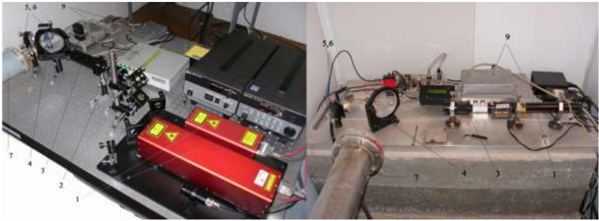
Рисунок 1.1 – Интерферометры лазерного деформографа плеча 52,5 м (слева) и плеча 17,5 м (справа)
