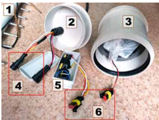
Рис. 2. Сборка АМЗИТ-2025: 1 – Полипропиленовая основа с датчиками; 2 – Крышка гермокорпуса с закрепленным коннектором, связывающим блок управления с датчиками; 3 – Гермокорпус для размещения блока 5 и аккумуляторной батареи; 4 – Герметичные коннекторы типа «папа»; 5 – Отдельный блок с контроллером и часами, во время работы герметизируется; 6 – Герметичные коннекторы типа «мама»
