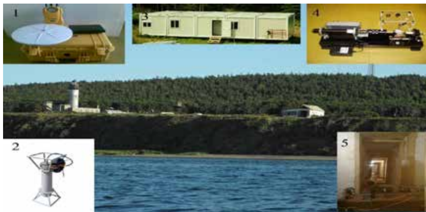
Рис. 1. Лазерно-интерференционный комплекс на базе СКБ САМИ ДВО РАН «м. Свободный» 1 – GPS-приёмник TRIMBLE 5700; 2 – лазерный гидрофон; 3 – лабораторное помещение; 4 – лазерный нанобарограф; 5 – лазерный деформограф горизонтального типа
