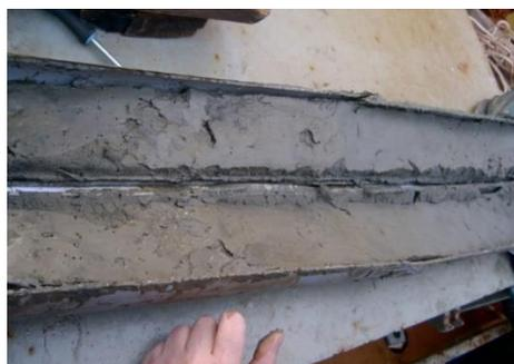
Рисунок 2.1.9. Разрез донных отложений, отобранных гравитационной трубкой.
