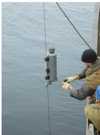
Рисунок 2.1.11. Пятилитровый батометр для взятия проб придонной воды. Фото: ФГБУ «ВНИИОкеангеология»
