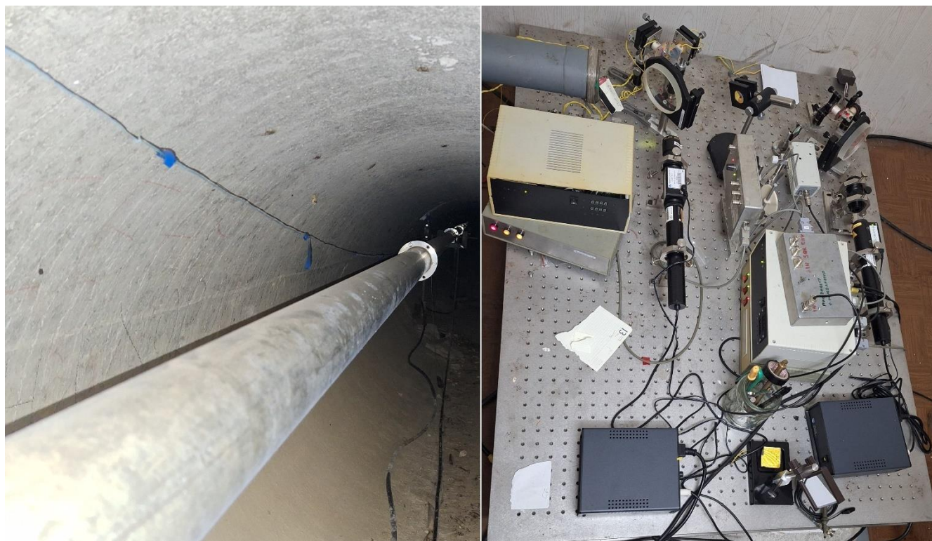
Рис. 1.9. Подземный лучевод 52.5-метрового лазерного деформографа неравноплечего типа и центральный интерференционный узел.
