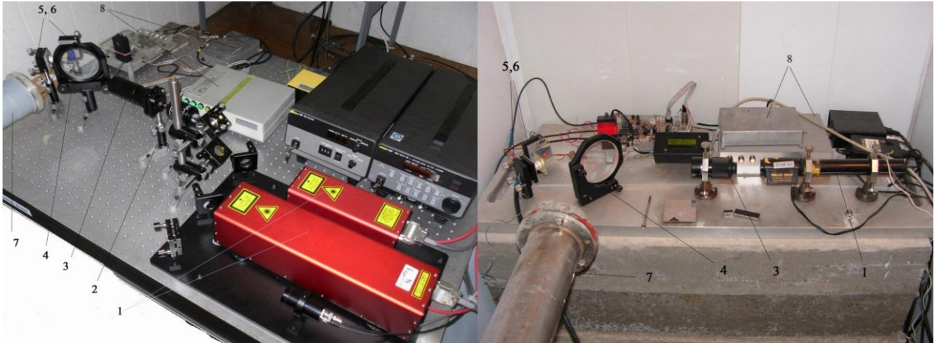
Рисунок 1.2 – Интерферометры лазерного деформографа с длиной измерительного плеча 52.5 м ориентацией «Север–Юг» (слева) и с длиной измерительного плеча 17.5 м ориентацией «Запад–Восток» (справа). 1 – лазер, 2 – оптический затвор, 3 – коллиматор, 4 – плоскопараллельная пластина, 5 и 6 – юстировочные зеркала на пьезокерамических цилиндрах, 7 – лучевод, 8 – система регистрации.
