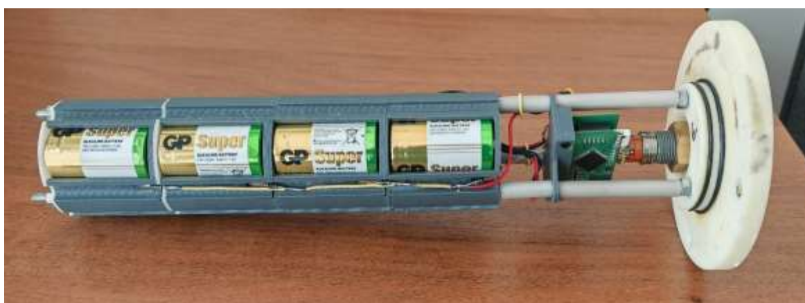
Рисунок 1.25 – Волнограф. Внутреннее устройство. (Пластиковый корпус).
