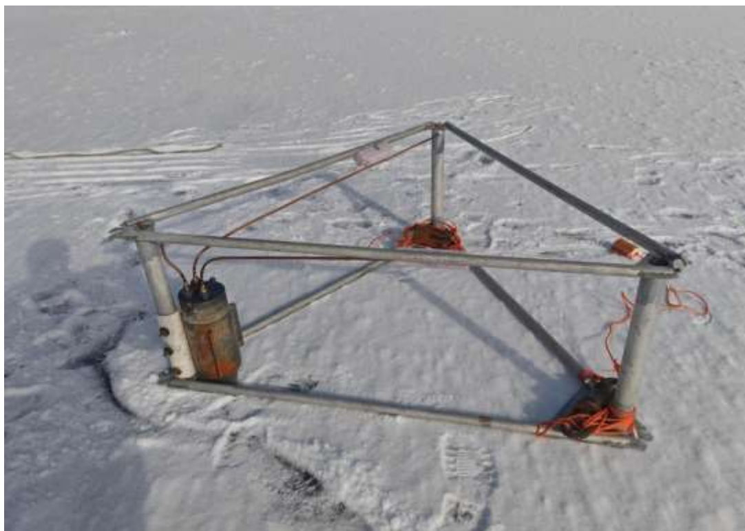
Рисунок 3.3 – Внешний вид устройства волнограф с тремя равноудаленными измерительными датчиками
