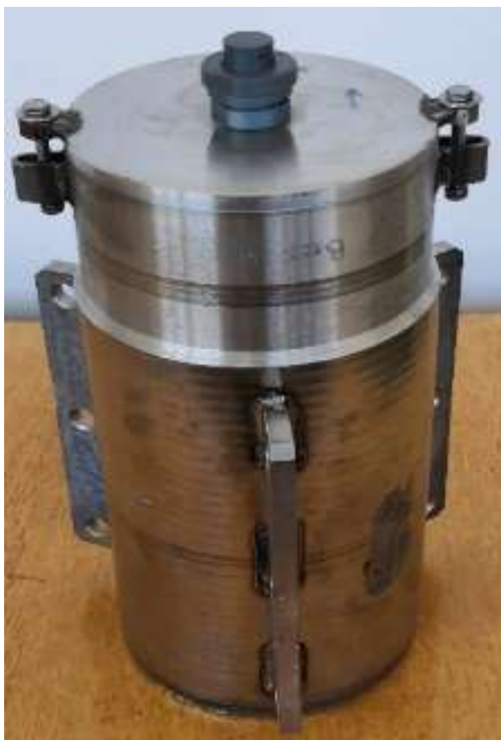
Рисунок 1.24 - Волнограф. Вид общий. (корпус из нержавеющей стали).
