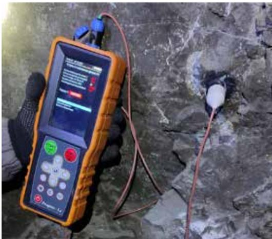
*Рис. 2. Прибор «Prognoz L2» в режиме проведения измерений*
