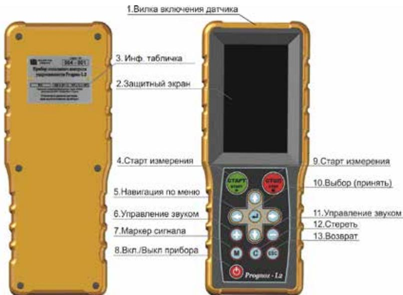
Рис. 1. Внешний вид и функции управления прибором «Prognoz-L2»
