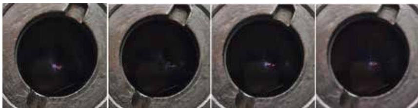
Рис. 6. Фотографии СЛ водного раствора 5М CaCl<sub>2</sub>. Экспозиция 1/7 сек. Фокус а) окно б) ~10 мм от окна в) ~20 мм от окна г) ~50 мм от окна вглубь. Использована заслонка, которая видна как мутный желтоватый овал в глубине. Видны 3-4 соединяющихся голубых стримера и яркий красный хвост, направленный к окну
