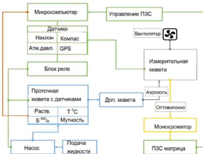
Рис. 1. Блок-схема автоматизированного комплекса для исследования гидрофизических и спектральных характеристик морской воды
