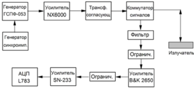
Рис. 1. Функциональная схема аппаратного комплекса для измерения рассеяния звука на частоте 12.4 кГц.
