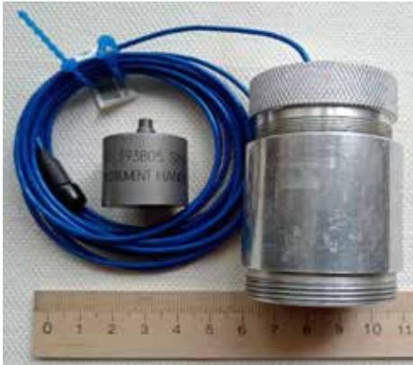
Рис. 1. Внешний вид акселерометра 393B05 и герметичного корпуса ПГД
