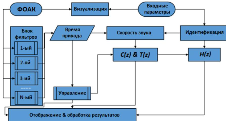
Рисунок 2.11. - Общая структура графического интерфейса программы *МИК*
