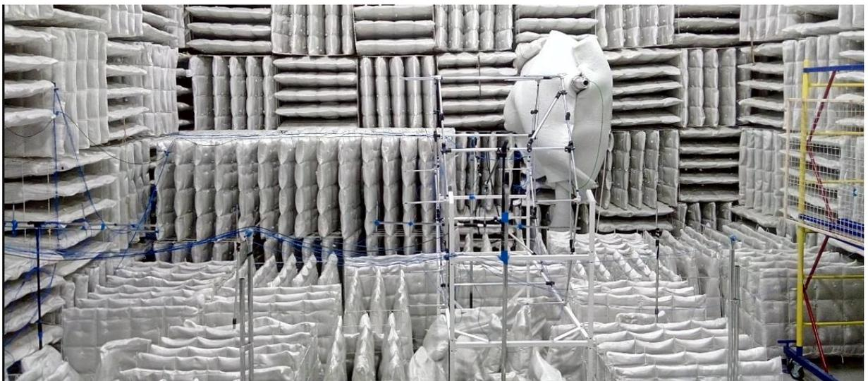
Рис. 13. Схема эксперимента (а) и многоканальная микрофонная система, установленная в заглушенной камере ПНИПУ (б)
