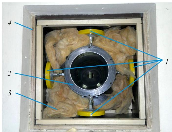
Рис. 6. Сборка генератора вихревых колец: 1 – виброопоры; 2 – полый цилиндр; 3 – звукопоглощающий материал; 4 – фанерный кожух
