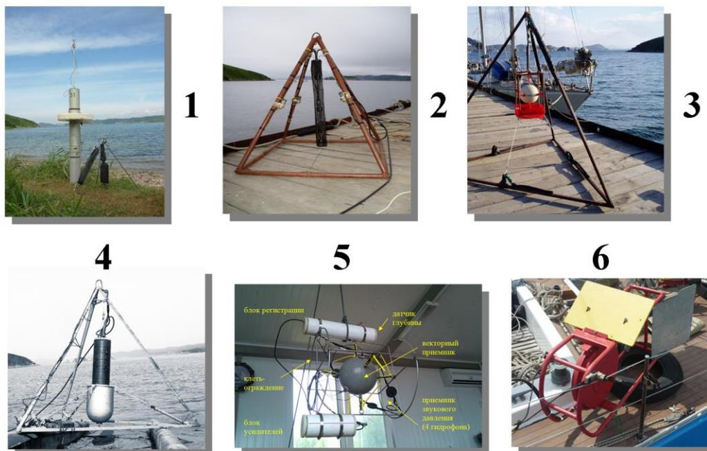
Рисунок 2 – Технические средства: 1 - мобильная автономная приемная система на базе радиогидроакустического буя; 2 - стационарная приемная система; 3 - комбинированный (векторный) приемник; 4 – трансивер 6 кГц; 5 - автономная приемная система с использованием комбинированного приемника; 6 - буксируемый гидроакустический излучатель.
