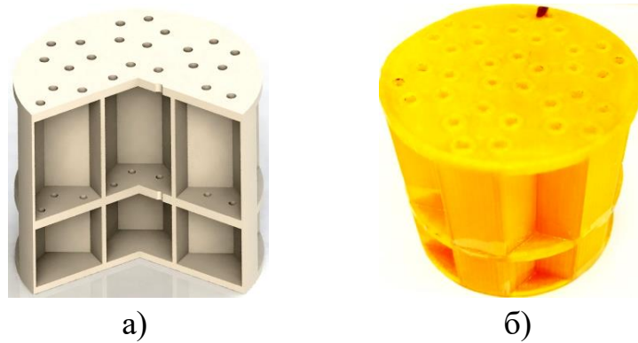
Рис. 70. Образец двухслойной сотовой ЗПК: а) модель; б) изготовленный образец
