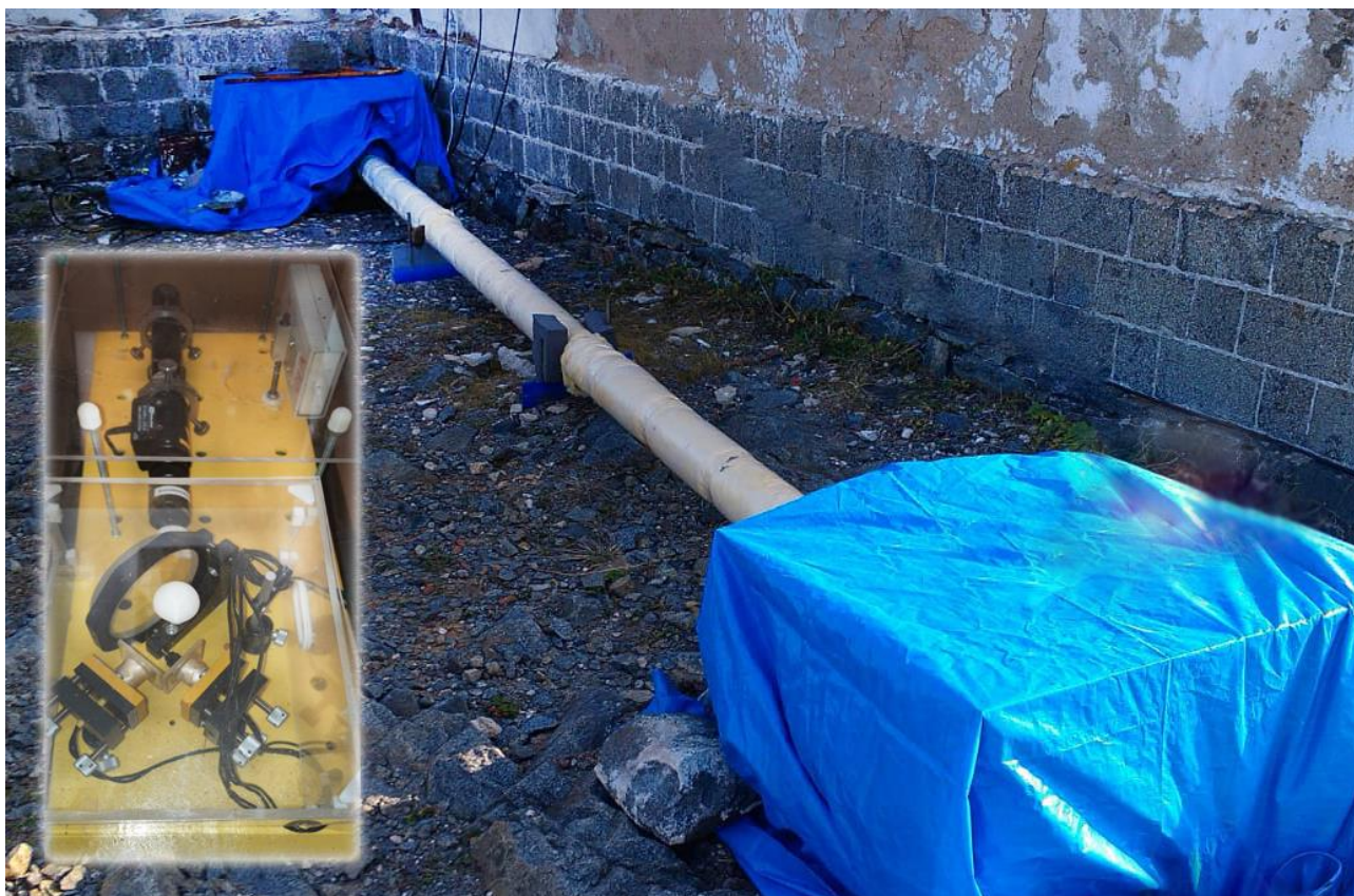
Рисунок 3.7 – Мобильный лазерный деформограф в рабочем режиме на м. Гамова
