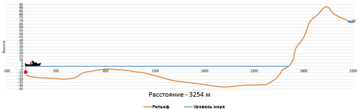
Рисунок 4.10 – Изменение границ вода–дно и верхний слой земной коры–воздух на участке излучение–приём.
