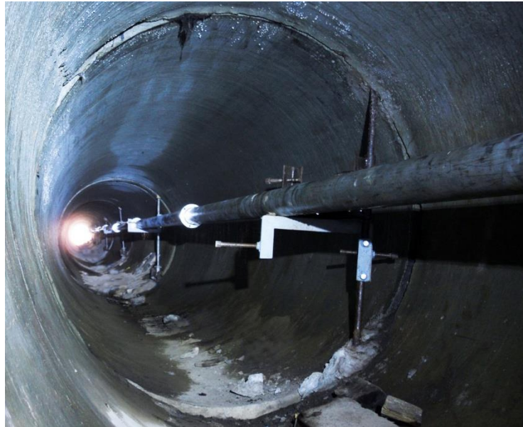
Рис. 1.4 – Лучевод измерительного плеча 52,5-метрового неравноплечего лазерного деформографа.
