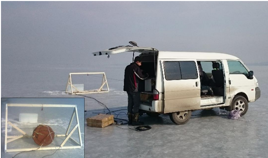
Рисунок 4.12 – Станция гидроакустического излучения в Амурском заливе
