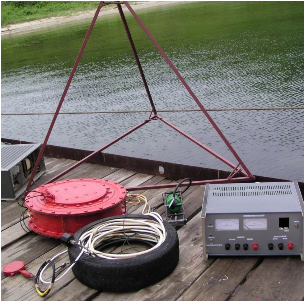
Рисунок 1.6 – Внешний вид излучающей гидроакустической системы 30–40 Гц
