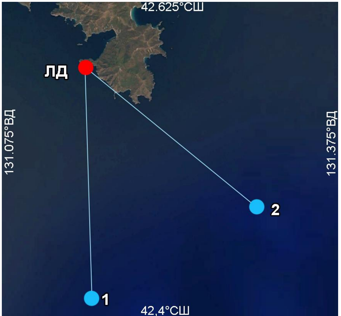
Рисунок 4.5 – Схема расположения станций гидроакустического излучения 1 и 2 относительно лазерного деформографа (ЛД).
