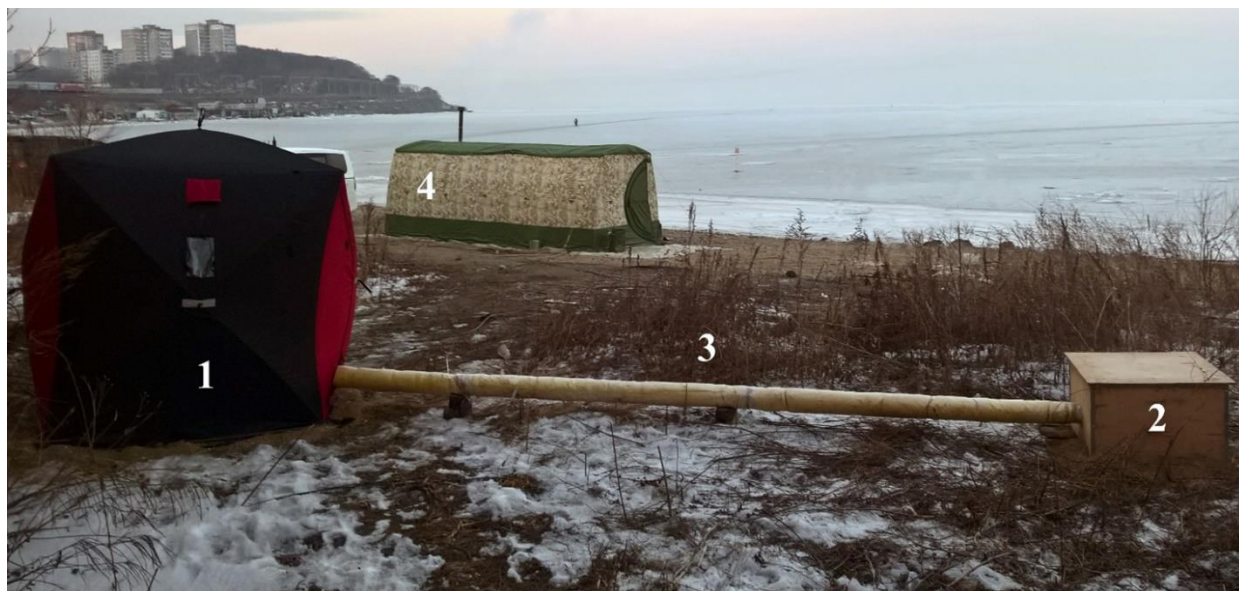
Рисунок 4.11 – Береговой пункт наблюдения: 1 – помещение основного интерференционного узла мобильного лазерного деформографа; 2 – бокс отражателя; 3 – лучевод; 4 – лабораторное помещение
