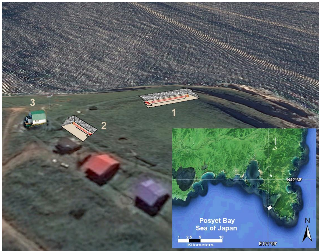
Рисунок 1.1 – Расположение компонент двухкоординатного лазерного деформографа с длинами измерительных плеч 52,5 м (1) и 17,5 м (2). 3 – лабораторное здание
