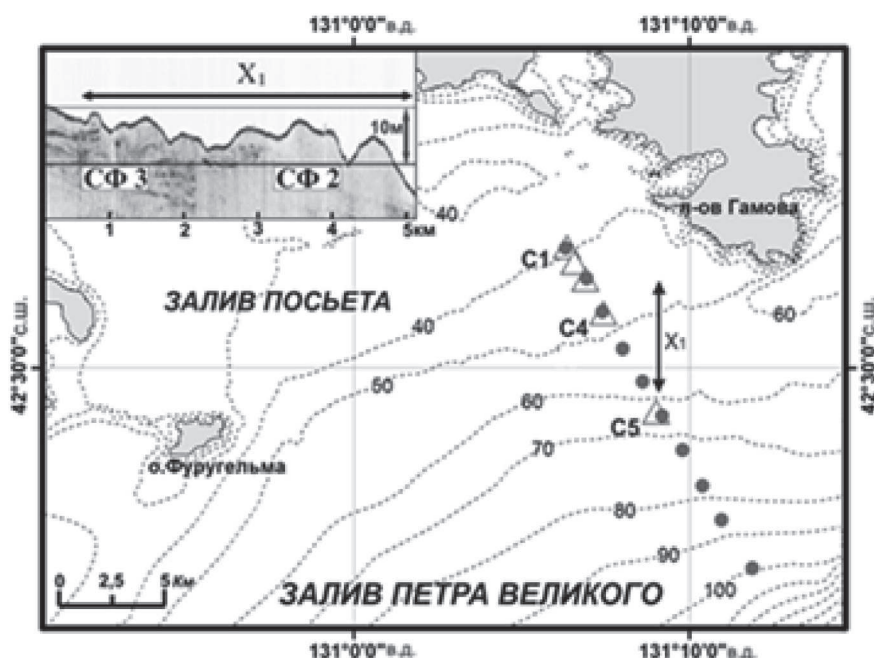
Рис. 2.1.1. Карта района океанологического эксперимента. Треугольниками отмечены точки постановки буйковых станций, круглые маркеры соответствуют точкам зондирования зондом СТД. На врезке и на основном рисунке отрезком X_1 отмечен пример осадочных волн
