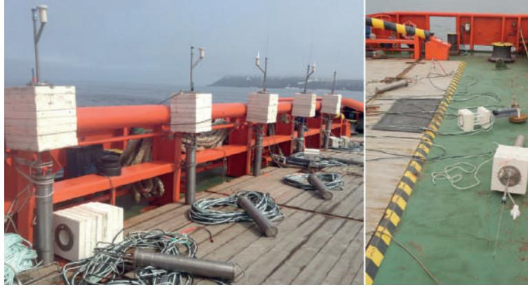
Рис. 2.8. Автономные акустические регистраторы УКВ-АПАР-Иридиум, подготавливаемые к постановке на северо-восточном шельфе о. Сахалин, оснащенные цифровыми УКВ радиотелеметрическим и спутниковым «Иридиум» каналами
