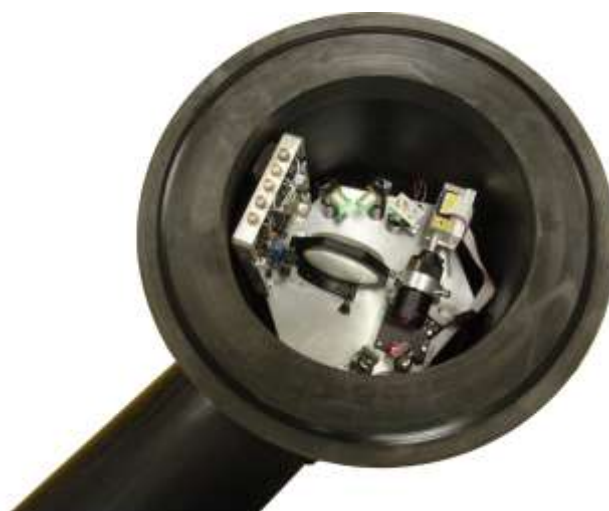
Рисунок 1.4 – Установленная внутри корпуса прибора оптическая скамья с компонентами интерферометра на основе зеленого полупроводникового лазера с системой регистрации
