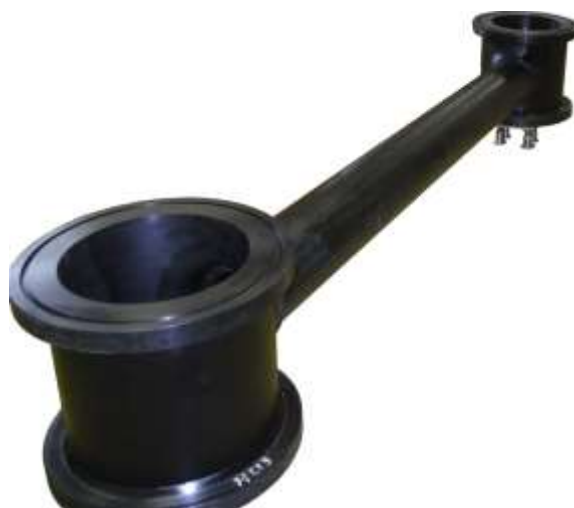
Рисунок 1.3 – Корпус прибора с установленными грунтозацепами (в чехлах)
