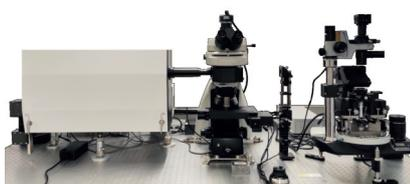
Одновременные исследования образцов методами сканирующей зондовой микроскопии и конфокальной микроскопии/ спектроскопии комбинационного рассеяния (Раман)
