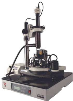
Поддержка всех существующих методик измерений (атомно-силовая микроскопия, магнитно-силовая микроскопия, электро-силовая микроскопия, силовая микроскопия пьезоотклика, измерения в вакууме, в жидкости, электрохимических средах и др.)
