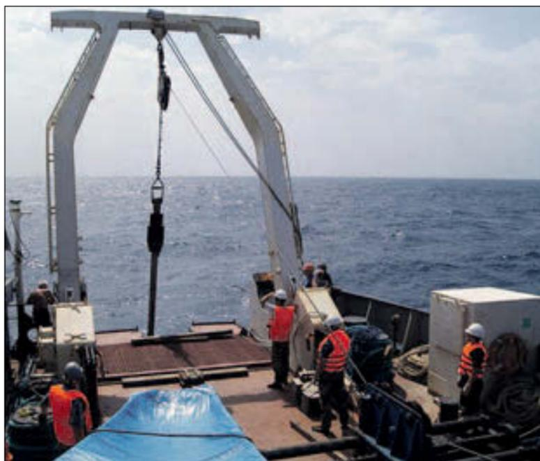
Подъём колонкового гравитационного пробоотборника с керна осадочных отложений на борт судна
