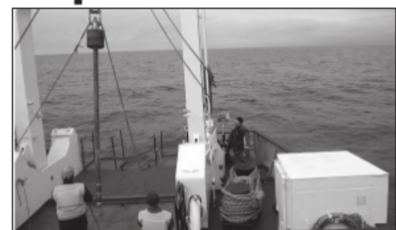
Отбор донных отложений гравитационным прямоточным пробоотборником. Пробоотборник изготовлен на ДВЗ «Звезда», г. Большой Камень
