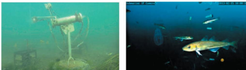
Рис. 10.27. Система долговременного подводного видеонаблюдения (СДПВ) (слева) и полученное изображение (справа)
