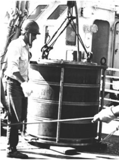
*Рис. 4.19.* Д.Н. Шеховцов рядом с пьезокерамическим излучателем
