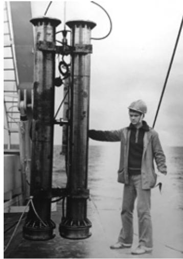
*Рис. 4.20.* С.И. Пенкин демонстрирует свою разработку – глубоководный волноводный излучатель (1985 г.)
