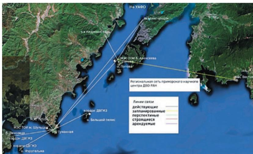
Рис. 10.15. Схема высокоскоростного интернета ДВО РАН в зал. Петра Великого
