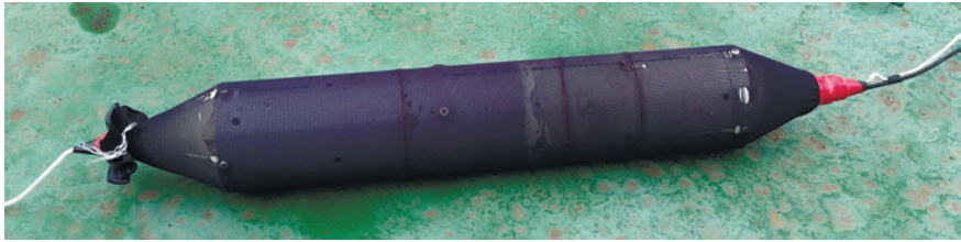
Рис. 2. 3-компонентный ПГД инерционного типа с акселерометрами РСВ Piezotronics 393В05 в обтекателе Ø100 мм, предназначенный для горизонтального развертывания
