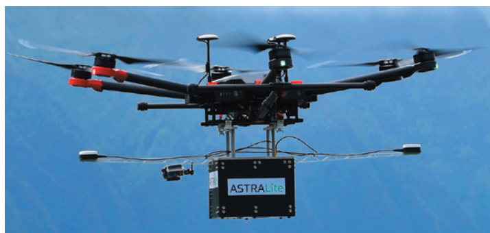
Рис. 2. Лидар Edge компании Astralite на БПЛА DJI Matrice 600 Pro (по: https://hightech.plus/2019/10/21/sozdan-pervii-kompaktnii-lidar-dlya-podvodnih-issledovaniy )
