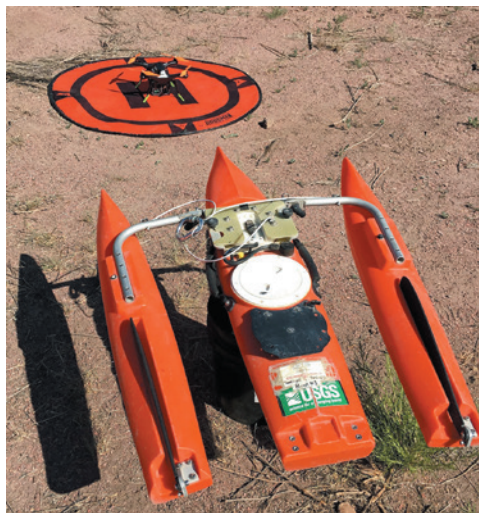
Рис. 3. Дрон с геолокатором и акустический профилограф перед экспериментом (по: https://www.usgs.gov/centers/co-water/science/radar-drones? )
