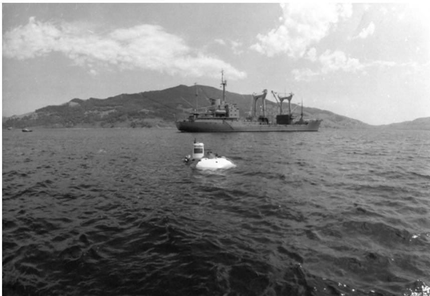
*Испытание подводного аппарата Океанолог. Название аппарат получил
