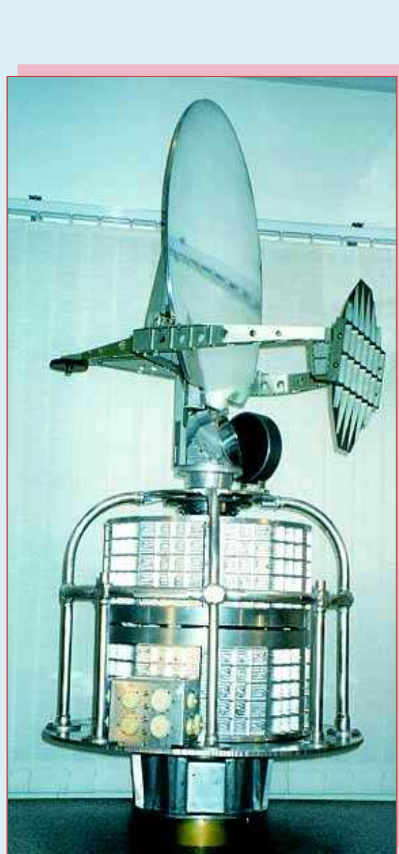
Рис. 1. Микроволновый сканер-зондировщик MTB3A КА «Метеор-3М». Запуск – 2001.
