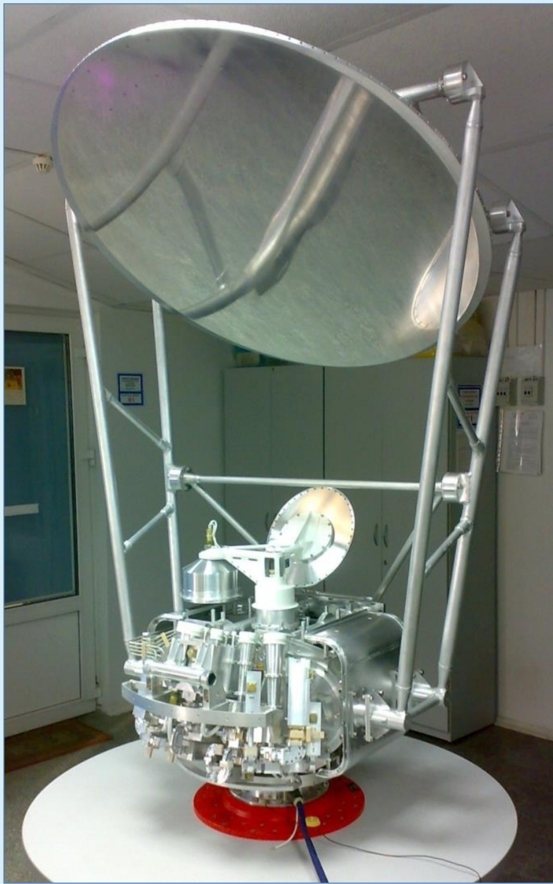
Рис. 5. Микроволновый сканер/зондировщик/поляриметр MTB3A-ГЯ-МП КА «Метеор-МП». Апертура антенны 1 м. Запуск – после 2024.
