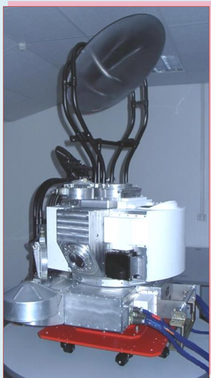
Рис. 2. Микроволновый сканер-зондировщик MTB3A-OK КА «Сич-1М». Запуск – 2004.
