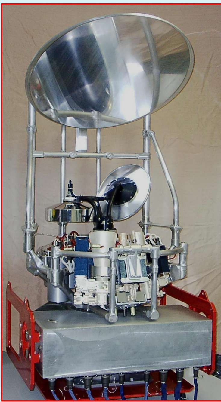
Рис. 3. Микроволновый сканер-зондировщик MTB3A-ГЯ КА «Метеор-М». Запуск – 2009, 2014, 2017, 2019.
