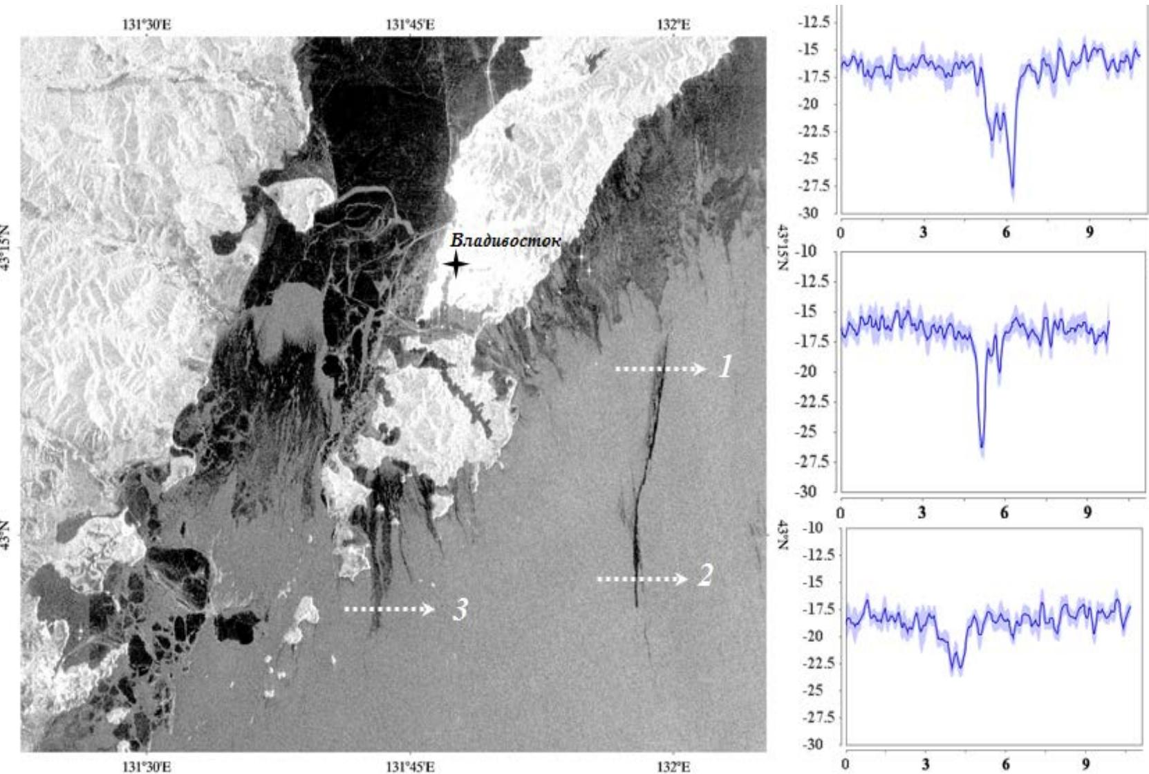
Зал. Петра Великого на изображении РСА PALSAR-2 на ГГ поляризации со спутника ALOS-2 30 декабря 2017 г. в 03:22 Гр. (а) и профили УЭПР вдоль сечений 1, 2 и 3 через полосы ледяного сала.
