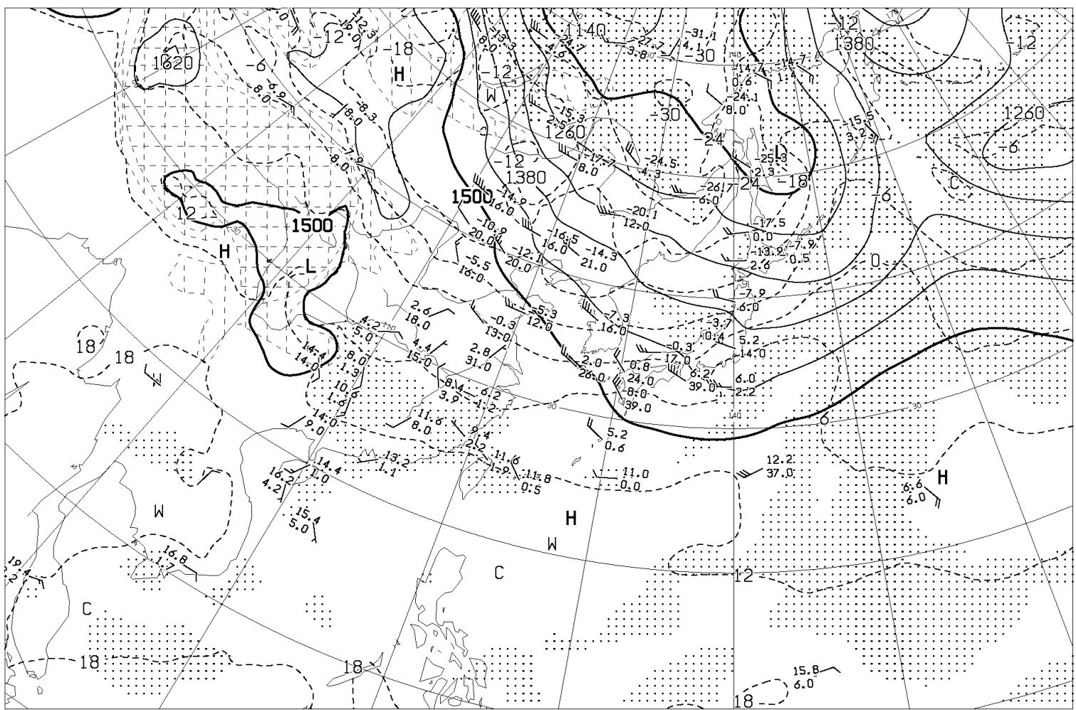
ANALYSIS 850hPa: HEIGHT(M), TEMP(°C), WET AREA::(T-TD<3°C)
